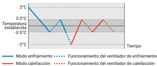
El ajuste de cambio automático permite que el producto cambie fácilmente entre los modos de refrigeración y calefacción, independientemente del modo de funcionamiento de otras unidades interiores. Esto se puede hacer a través de una unidad interior específica con mando a distancia con cable. Esto garantiza un funcionamiento confortable durante todo el año.
