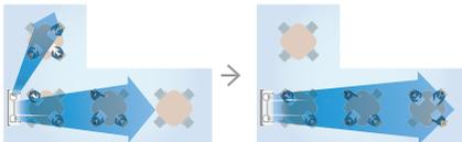
El ajuste adecuado de los puertos de salida de aire lateral para adaptarse al uso del espacio permite una optimización total del aire acondicionado.
