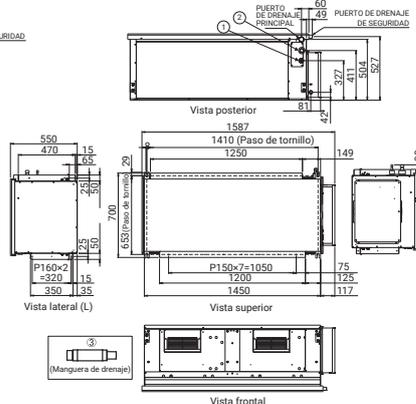
① Conexión abocardada de tubería de refrigerante (líquido)
