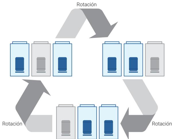
Nota: La operación de rotación se alterna con el tiempo de inicio / parada del compresor.
