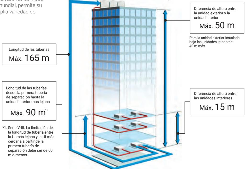
\*1: Serie V-III. La limitación de la longitud de tubería entre la UI más lejana y la UI más cercana a partir de la primera tubería de separación debe ser de 60 m o menos.
