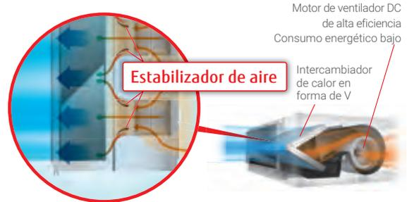
Motor de ventilador DC de alta eficiencia
