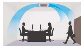
Aire acondicionado confortable, evitando la emisión directa de aire frío y proporcionando un caudal de aire oscilante de forma simultánea.
