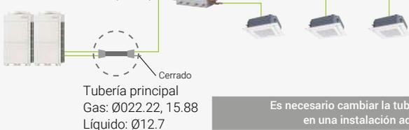
Es necesario cambiar la tubería principal en una instalación adicional
