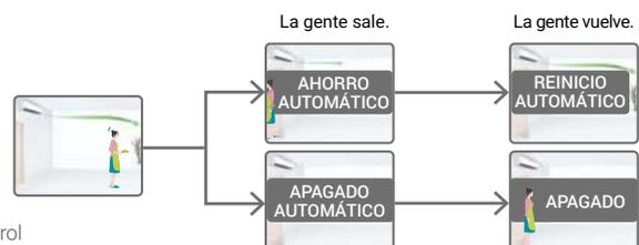
\* Para utilizar la función de control del sensor de ocupación, es necesario contar con un control que permita configurarla. Por ejemplo: control remoto con cable (panel táctil).
