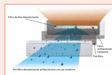
Desodorização e purificação do ar.
